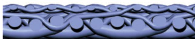
Figura 2: Tela SSB após processo de calandragem
